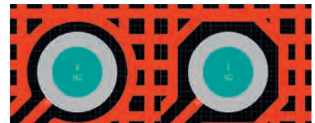
Примечание: левая контактная площадка огибается дугой, правая – восьмиугольником Рис. 22. Пример использования параметра Surround Pads With
